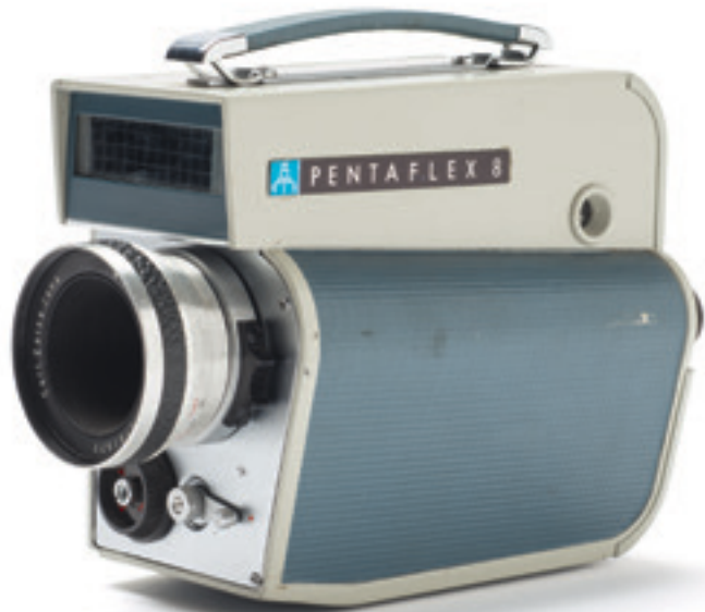
Pentaflex 8 8 mm Schmalfilmkamera, Bj. 1960 Hersteller: VEB Kamera- und Kinowerke Dresden Kunststoff, Metall, Glas 14 × 9 × 17,2 cm; 3,5 kg
