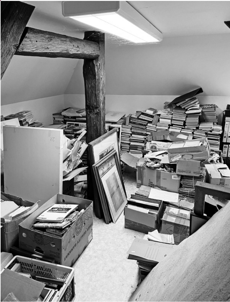
Eine Überbelegung des Depots mit brennbaren Dingen führt in der Regel zu einem enormen Anstieg der Brandlast. Wird diese nicht erkannt und beseitigt, kann das katastrophale Folgen haben.
