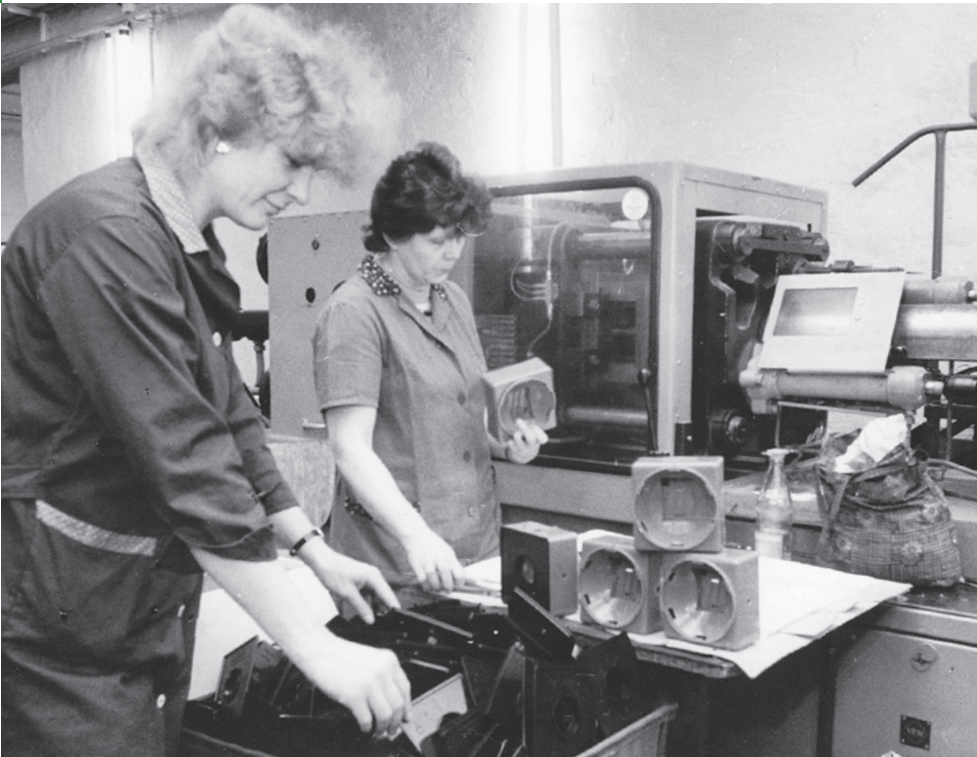
Produktion am Spritzgießautomaten im VEB Plastverarbeitung Falkensee, 1986. Das Spritzgießen ist ein Verfahren in der Kunststoffverarbeitung. Mit einer Spritzgießmaschine wird dabei der jeweilige Werkstoff verflüssigt und in eine Form unter Druck eingespritzt.
