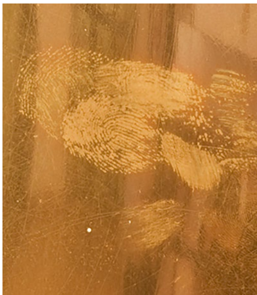
Abb. 4: Detailsicht der Oberfläche: Massenhafte Berührungen mit bloßen Händen haben korrodierte Fingerabdrücke auf der Skulptur hinterlassen. Fotos: Christoph Wenzel
